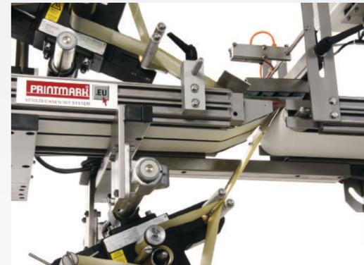
Basic 2200 in Edelstahlausführung. Geteiltes Förderband, reduzierte Umlenkwalze und Laserlichttaster zur Erkennung flacher Produkte
